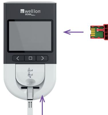
Setzen Sie den Codechip in den vorhandenen Steckplatz ein. Der Bildschirm zeigt nach einigen Sekunden die CODE Nummer an. Stellen Sie sicher, dass die auf dem Bildschirm angezeigte Codenummer mit der auf dem Codechip und der Teststreifenverpackung angegebenen Nummer übereinstimmt.
